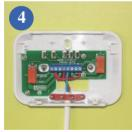
Подсоедините провода к приемнику по одной из схем на страницах 4 и 5
