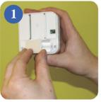
Снимите крышку батарейного отсека на залней стенке iT300 блока.
