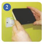
Убедившись, что кронштейн надежно закреплен, зафиксируйте iT500. Для этого сначала совместите паз на задней панели устройства с кронштейном и прищелкните его в установочном месте.
