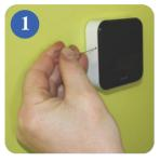
Для сопряжения iT300 с приемником, вставьте скрепку или аналогичный предмет в отверстие на левой стороне iT300 в течение 2 секунд.
