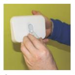
Для настольного использования термостата, просто прищелкните дополнительный упор (подставку) к задней панели устройства..
