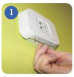
Используя скрепку, вставьте в отверстие, обозначенное SYNC в нижней части iT500RX приемника. Происходящее далее показано на следующем клипе.
