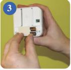
Закройте крышку батарейного отсека..
